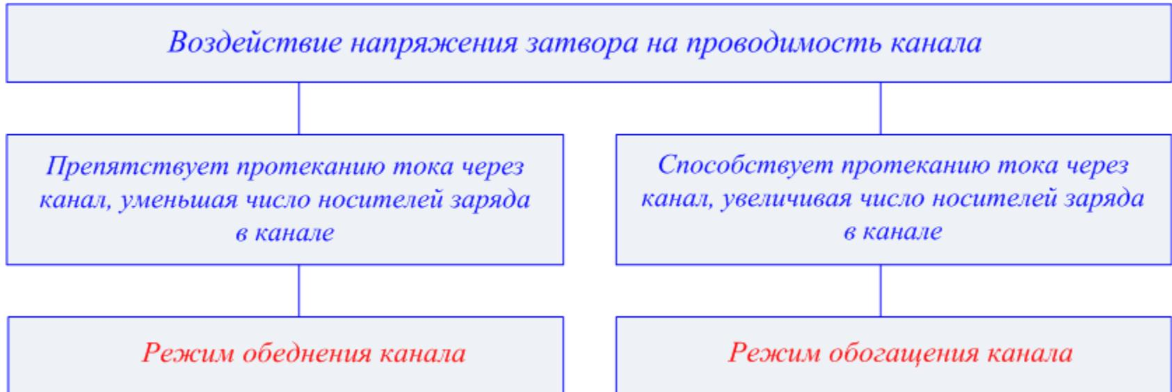
*Классификация полевых транзисторов по физической структуре и способу управления проводимостью канала*
