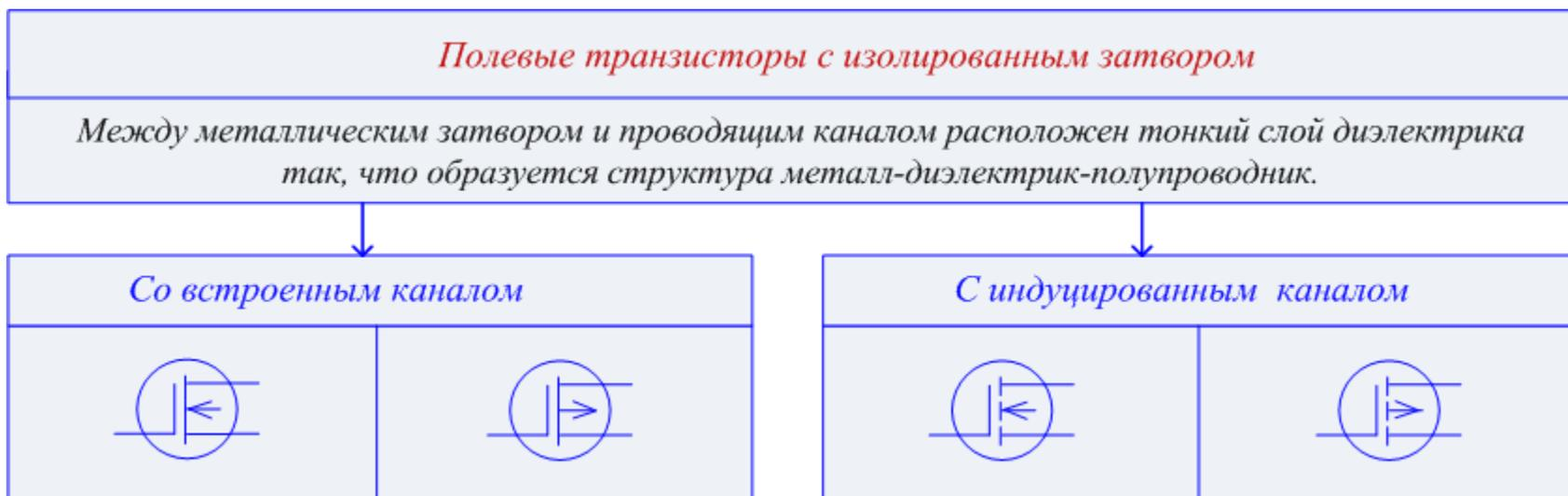
*Реализация транзисторов с изолированным затвором на основе МДП-структур обусловила другое распространенное их название – транзисторы типа металл-диэлектрик-полупроводник или **МДП-транзисторы**.*
