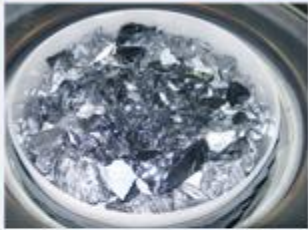
Кварцевый тигель, заполненный поликристаллическим кремнием
